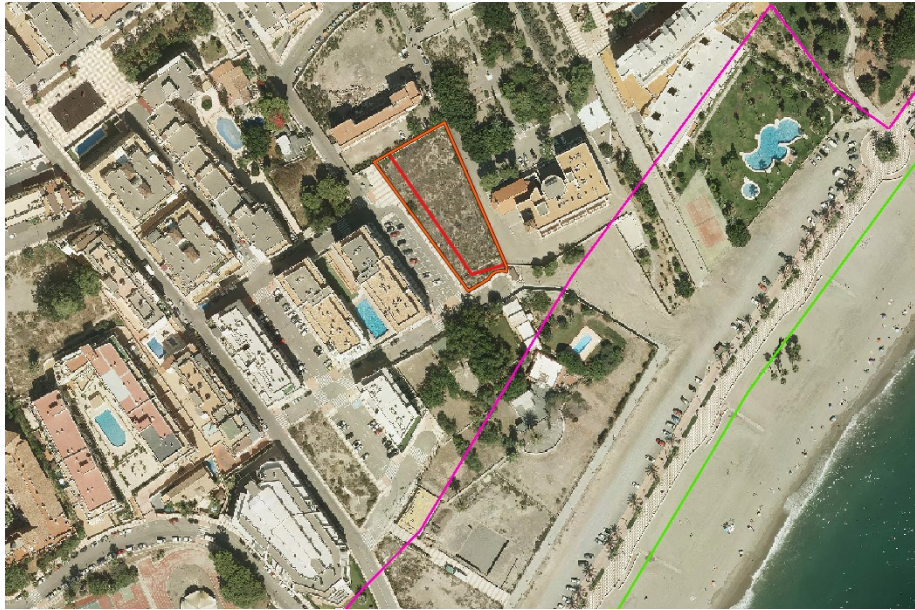
Figura 1. Alineación de la parcela y líneas DPMT y servidumbre de protección de Costas sobre Ortografía
