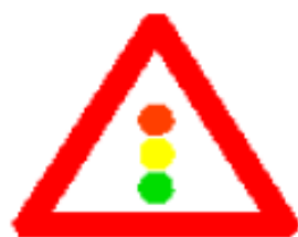
V-9. Peligro paso semaforizado
