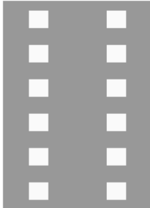
H-2 Paso para ciclistas sobre calzada
